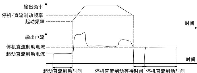
**⚠ 注意：** 对于高速或者大惯量的负载的启动，不宜采取先长时间直流制动再起动的的方式，建议使用跟踪启动方式。
