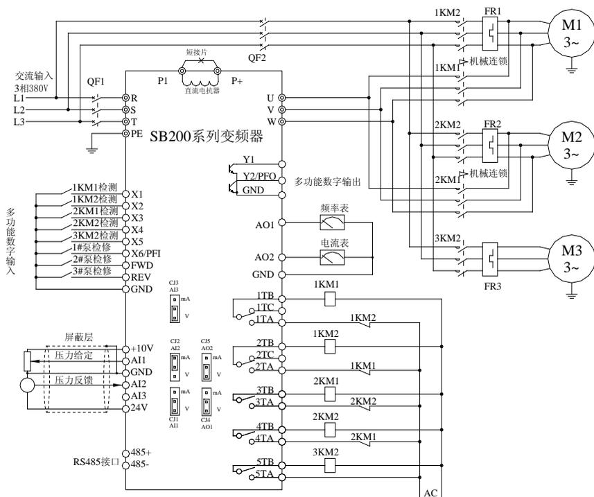
变频循环投切一控二和一台辅助泵的应用图
