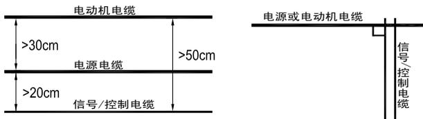
电机电缆越长或者电机电缆横截面积越大时，对地电容就越大，干扰相互耦合也越强，应该使用规定截面积的电缆，并尽量减小长度。
