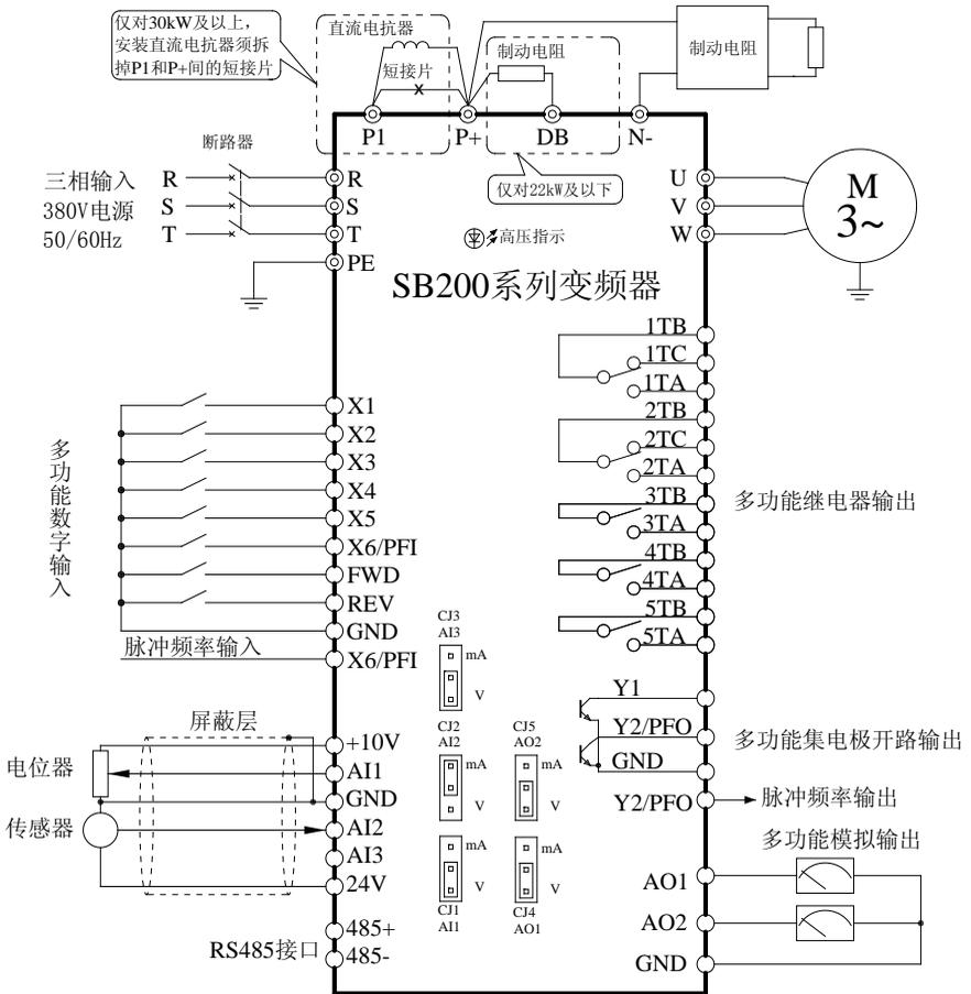
注：控制端子连接线建议使用1mm<sup>2</sup>的铜导线。
