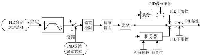
过程PID用于给定频率修正可以使变频器方便地用于主从同步或张力控制的场合。
