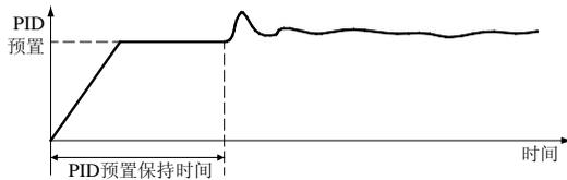
☞ 如果设置预置保持时间为零，则以预置值为积分器初值进行 PID 控制，相当于 PID 的预负载，可以提高起动时的响应速度。
