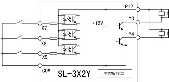
数字I/O扩展板提供多路数字输入输出量,可由用户定制。例如:5路数字输入型(SL-5X)、5路数字输出型(SL-5Y)、3路数字输入2路数字输出型(SL-3X2Y)等。以SL-3X2Y为例,功能及规格如下:
