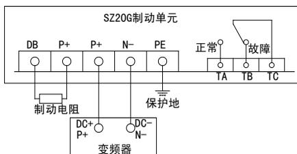
制动单元和变频器、制动单元和制动电阻之间的接线应在5m以内，并且使包围回路面积最小。
