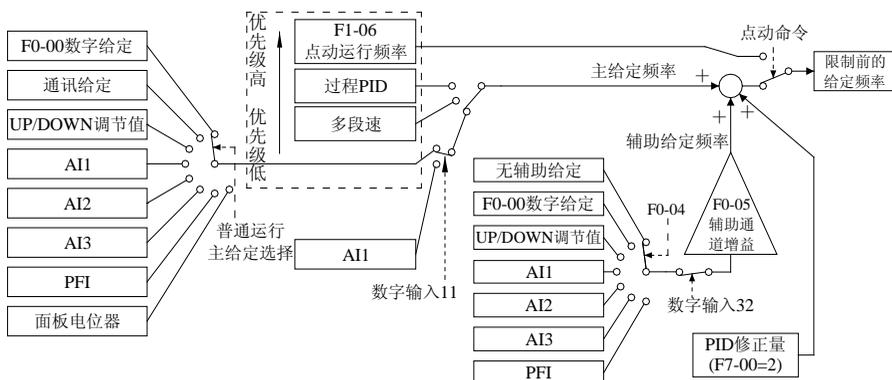
变频器有4种运行方式, 优先级由高到低依次为点动、过程PID、多段速、普通运行。例如: 在普通运行时, 如果多段速有效, 则主给定频率由多段频率确定。
